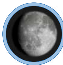
TFOV > MFOV Viñeteo de aproximadamente un 20% en diámetro
